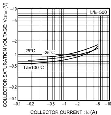
Fig.7 コレクタ・エミッタ間飽和電圧-コレクタ電流特性 (II)
