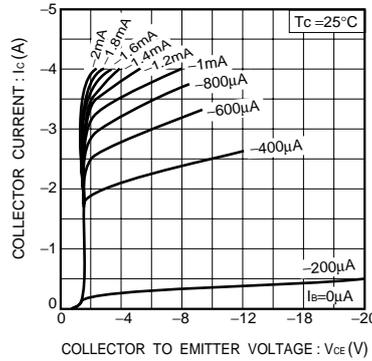
Fig.2 エミッタ接地出力静特性 (II)
