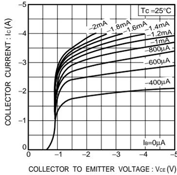
Fig.1 エミッタ接地出力静特性 (I)
